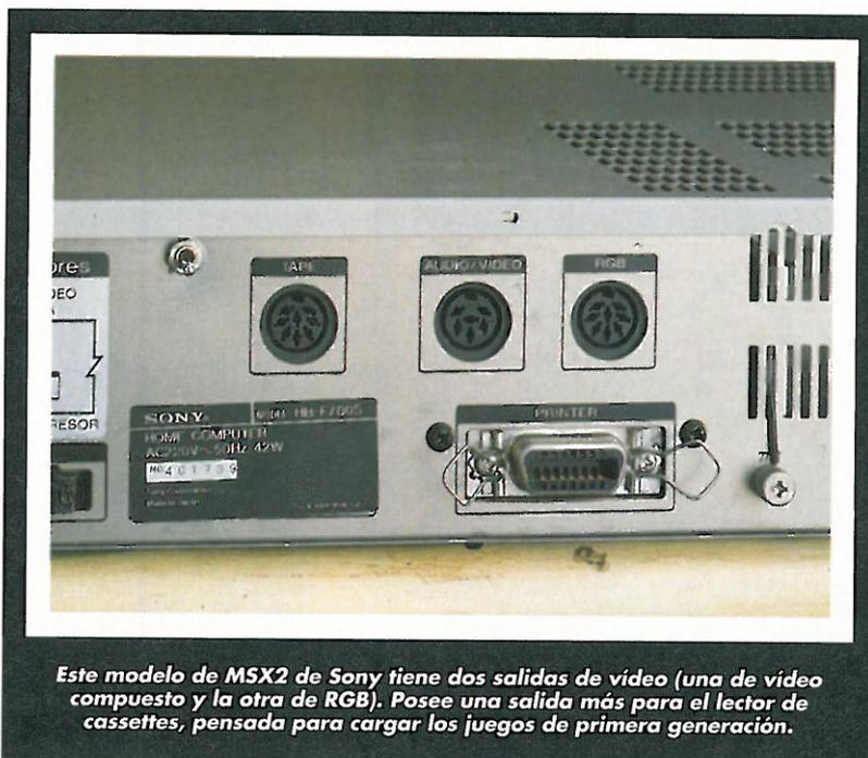
Este modelo de MSX2 de Sony tiene dos salidas de vídeo (una de vídeo compuesto y la otra de RGB). Posee una salida más para el lector de cassettes, pensada para cargar los juegos de primera generación.
